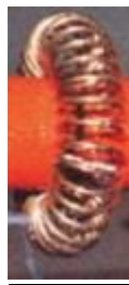
Hình 2. Bố trí thử nghiệm điện áp chịu đựng sào cách điện sử dụng điện cực tròn
