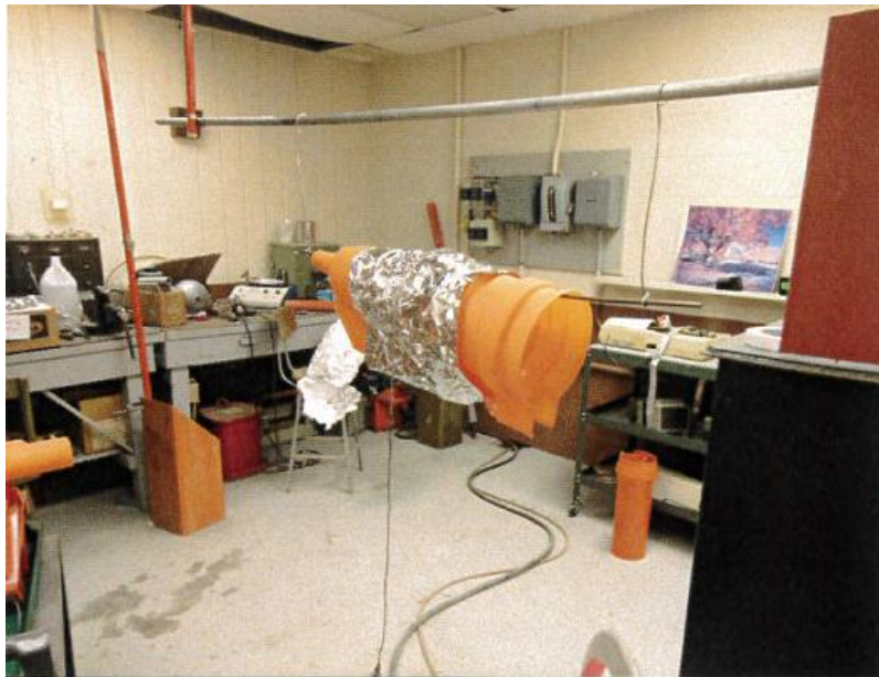
Hình 1. Bố trí thử nghiệm điện áp chịu đựng bọc sứ néo
