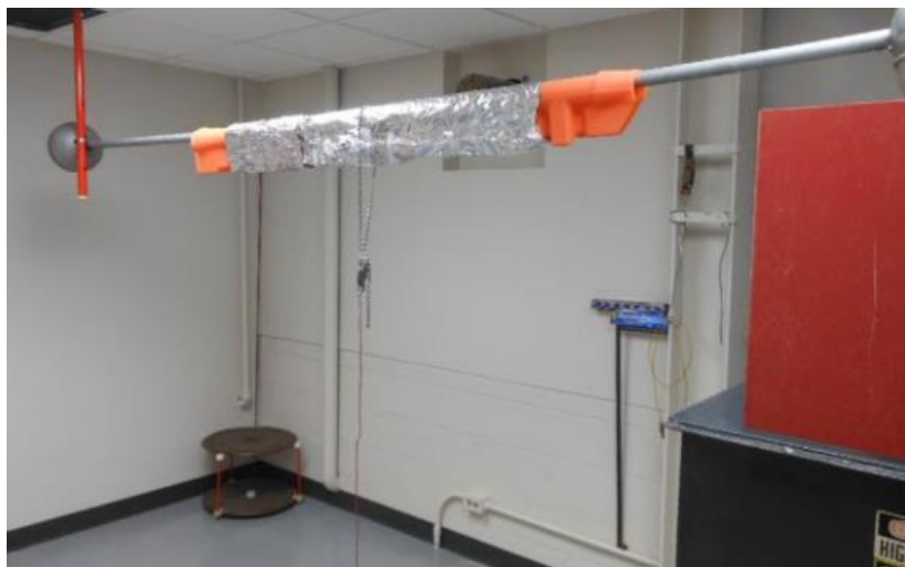
Hình 1. Bố trí thử nghiệm điện áp chịu đựng bọc dây cứng
